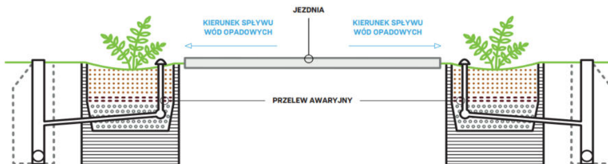
Ryc. 7.6. Przekrój przez drogę z kanalizacją otwartą z przelewem awaryjnym do kanalizacji zamkniętej
